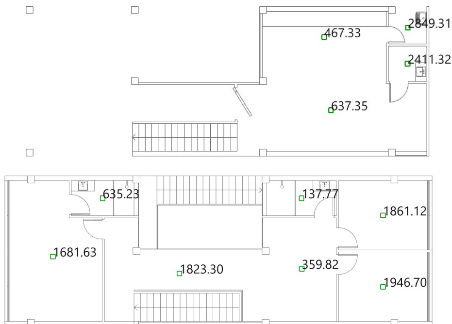
Figura 5.64 - Resultados da iluminação natural em 23/04 às 9:30
