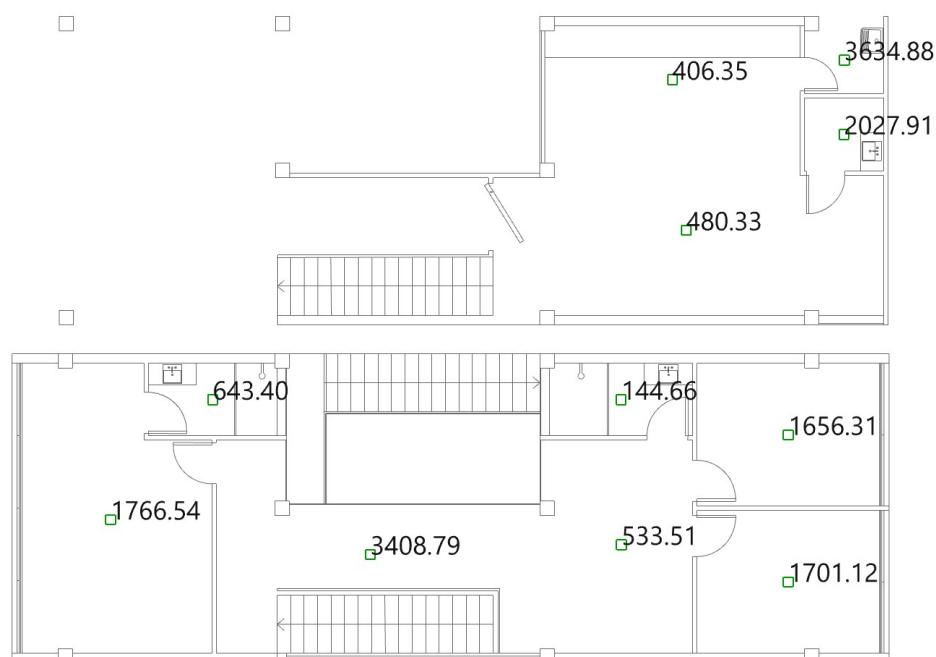
Figura 5.65 - Resultados da iluminação natural em 23/10 às 15:30
