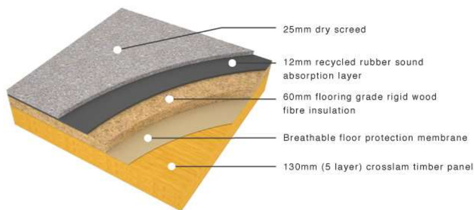
Figura 5.40 - Modelo esquemático de revestimento de piso em CLT
